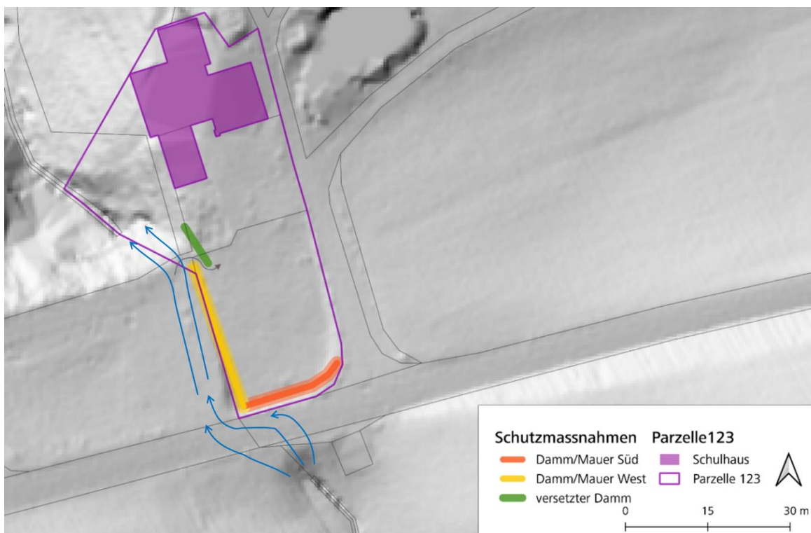
Abbildung 9: Situation der vorgeschlagenen Schutzmassnahmen (Variante Nr. 5 gem. Kapitel 4.1 und 4.2 und Tabelle 3 mit der Ausführung als Damm oder Mauer) sowie die Fliesswege nach Massnahmen (blaue Pfeile) und der Fussweg-Durchgang (grauer Pfeil) auf Parzelle 123. Quelle: Geodaten Kanton Bern.
